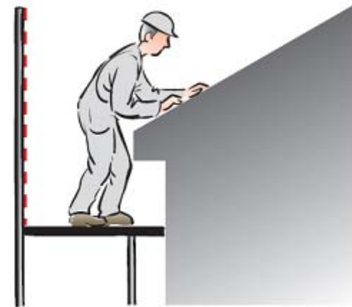
Byggnadsställning vid tak- och takfotsarbete.
