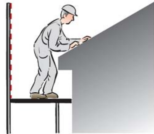
Byggnadsställning vid tak- och takfotsarbete.
